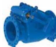
Seria 41/36 Clapetă de reținere cu buche izolatoare pe ax Etanșare metalică DN350-600 PN10/16 Fontă ductilă Opțiuni: • cu ax liber
