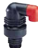
Seria 701/40 Ventil de aerisire combinat DN20, 25 și 50 Cu filet BSP ¾", 1" sau 2" PN16 Poliamidă ranforsată
