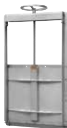
Seria 772/61 Stăvilă cu montare în perete Bidirecțional până la 1200 X 1200 mm, pentru dimensiuni mai mari bidirecțional sau unidirecțional Cu ax neascendent Oțel inoxidabil AISI 304 200 x 200 mm - 2000 x 2000 mm Opțiuni: • cu ax ascendent • oțel inoxidabil AISI 316
