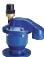
Seria 701/50 Ventil de aerisire combinat Conexiune prin flanșă la admisie DN50-300 PN16 Fontă cenușie / Poliamidă ranforsată
