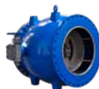
Seria 859/001X Vană de control Pentru menținerea presiunii DN50-600 PN10/16 Fontă ductilă / AISI 316
