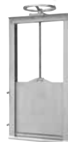
Seria 772/7172 Stăvilă cu montare în canal Unidirecțional până la 1000 x 1000 mm, bidirecțional pentru dimensiuni mai mari Cu ax neascendent Oțel inoxidabil AISI 304 200 x 200 mm - 2000 x 2000 mm Opțiuni: • cu ax ascendent • oțel inoxidabil AISI 316
