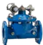
Seria 859/000X Vană de control Pentru reducerea presiunii DN50-600 PN10/16 Fontă ductilă / AISI 316
